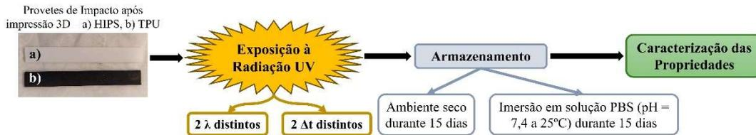
Figura 1 – Fluxograma da metodologia experimental adotada no trabalho.
