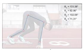
Figura 1 – À esquerda, um gráfico típico das curvas de força detetadas durante a partida. À direita, um *frame* típico sobreposto com os segmentos analisados e respetivos ângulos.
