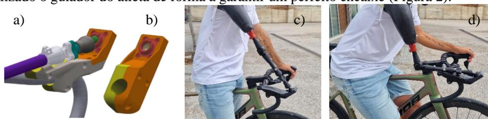
Figura 2 – Comparação entre apoio inicial (b), apoio melhorado (b), Segunda prova de conceito em duas posições: Extensão (c); Flexão (d).
